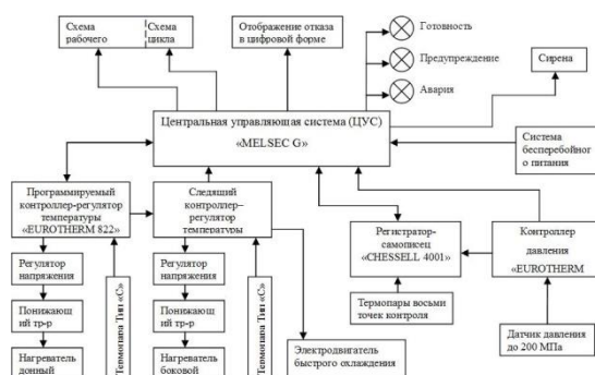
Рис.59. Блок-схема системы управления установкой горячего изостатического прессования.
