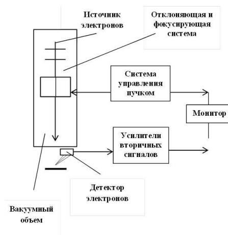
Рис. 65. Упрощенная блок-схема растрового электронного микроскопа.
