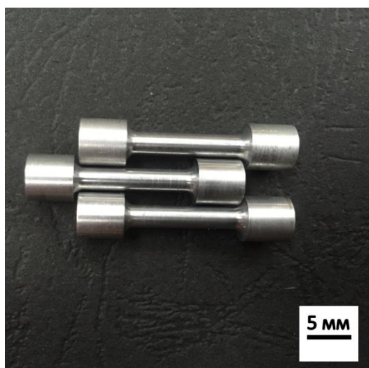
Рис. 126. Типичный вид образцов двойных силуминов одного состава для проведения механических испытаний.
